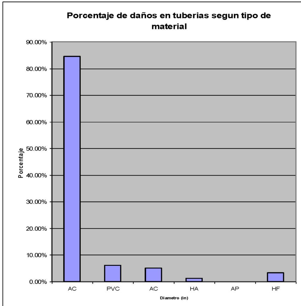
Figura 6-2 Grafica de porcentaje de daño en tuberías según tipo de material de informes de mantenimiento E.A.A.B.
