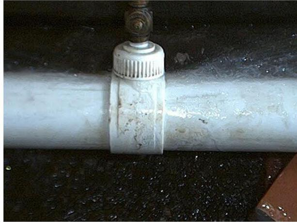
**Figura 8.1:** Fuga a través de un collar de derivación corrido al 50 % del diámetro del orificio de salida, evaluado con el acople para distribución cerrado.
