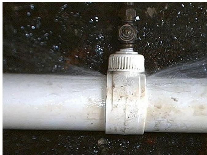
Figura 8.4: Fuga a través de un collar de derivación corrido al 100 % del diámetro del orificio de salida, evaluado con el acople para distribución cerrado.
