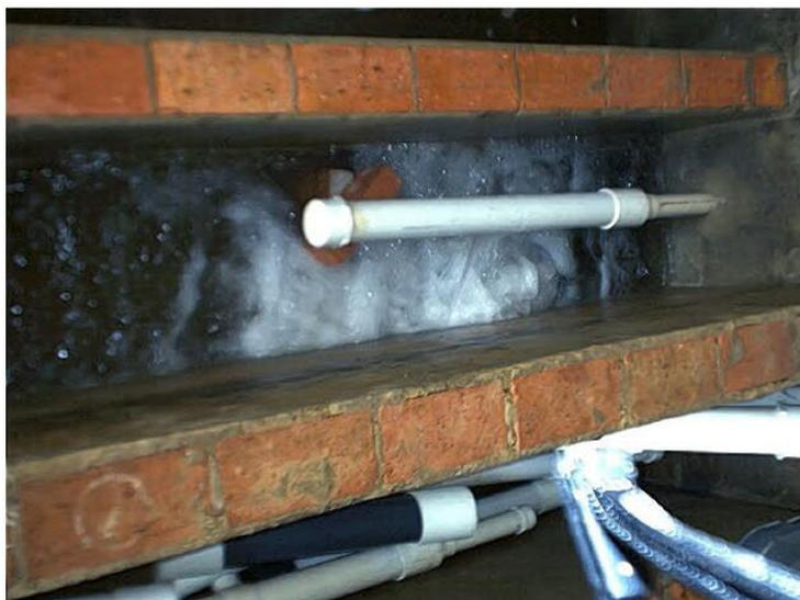
**Figura 7.2:** Ejecución de la prueba para una ranura real de 15.0 cm de longitud en una tubería de 3" de diámetro.
