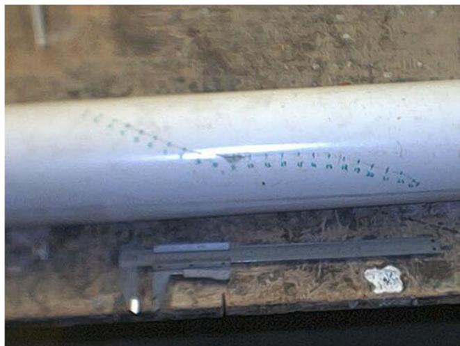
**Figura 5.1: Falla longitudinal real realizada en una tubería de 3" de diámetro.**
