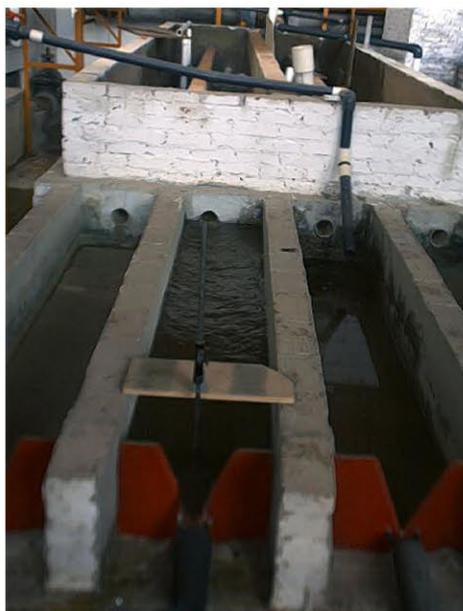
**Figura 4.3:** Canal No. 2 para pruebas, condicionado con los sistemas de aquietamiento.
