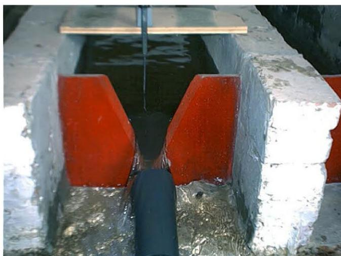
**Figura 4.5:** Vertedero triangular de 60° condicionado con su limnómetro.
