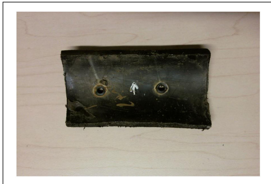
Figura 48. Crecimiento de biopelícula testigos de borde
