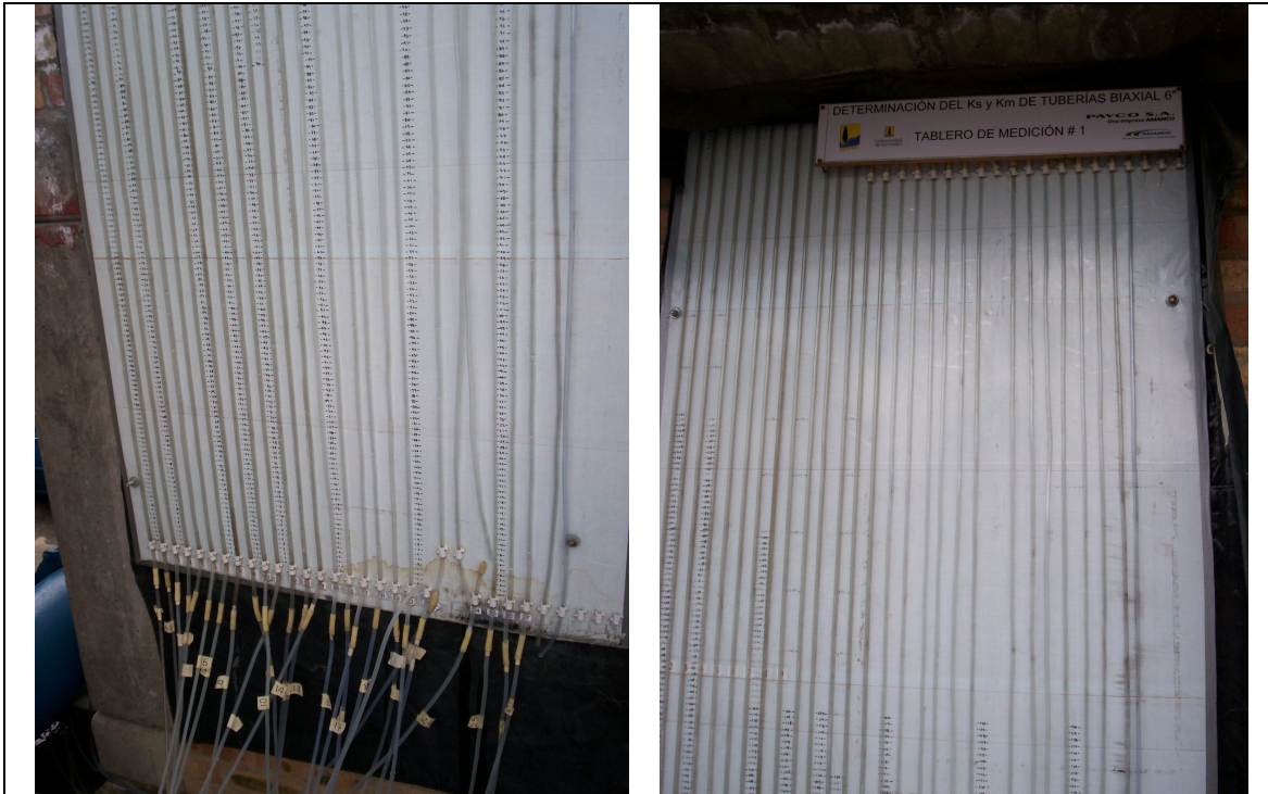
Figura 2-4 Tableros de medición de presiones.
