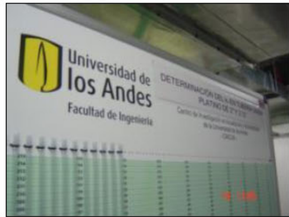
Figura 2-5. Piezómetros (a) Instalación. (b) Tablero de Piezómetros
