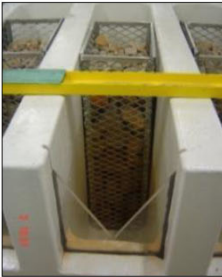
Figura 2-6. Vertederos para la medición de caudal.
