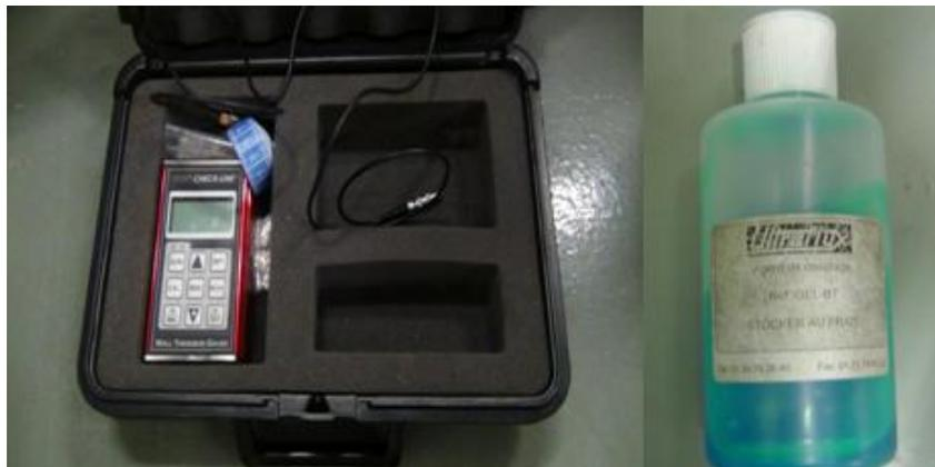
Figura 3-22. Micrómetro ultrasónico Electromatic y Gel ultraflux para realizar mediciones de espesor en tuberías de PVC.
