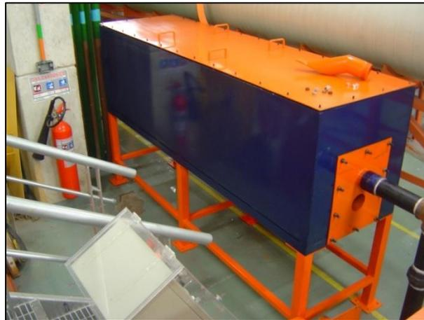
Figura 3-1. Tanque de abrasión y su base de soporte.
