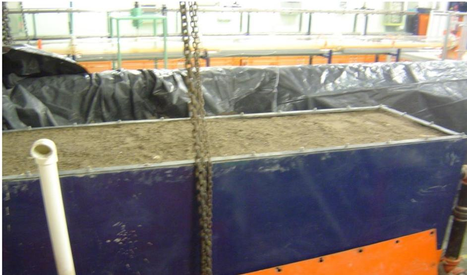
**Figura 3-28. Proceso de llenado y compactación estado final.**
