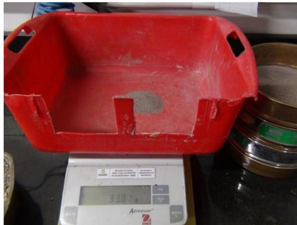
**Figura 4-7.**Balanza electrónica usada para pesar las muestras.
