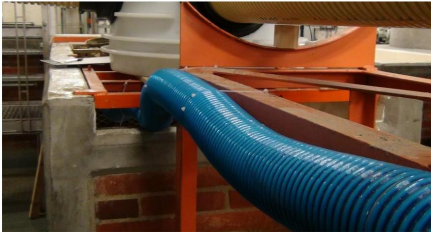
**Figura 3-15. Entrega del caudal de salida a un vertedero del laboratorio.**
