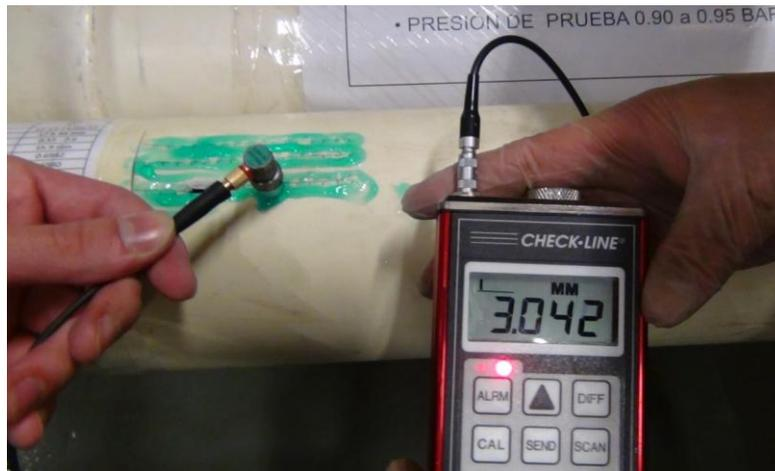
Figura 3-24. Medición en laboratorio del espesor de la tubería de PVC en la zona desgastada.
