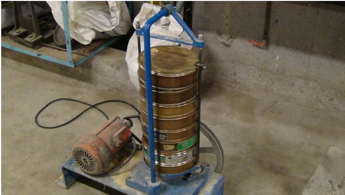
**Figura 4-8. Mezcla dentro de los recipientes y lista para ser procesada en la tamizadora mecánica.**
