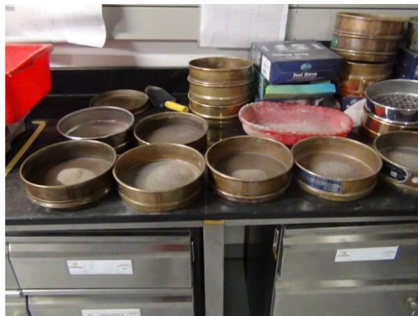
**Figura 4-5. Tamices seleccionados para la granulometría.**
