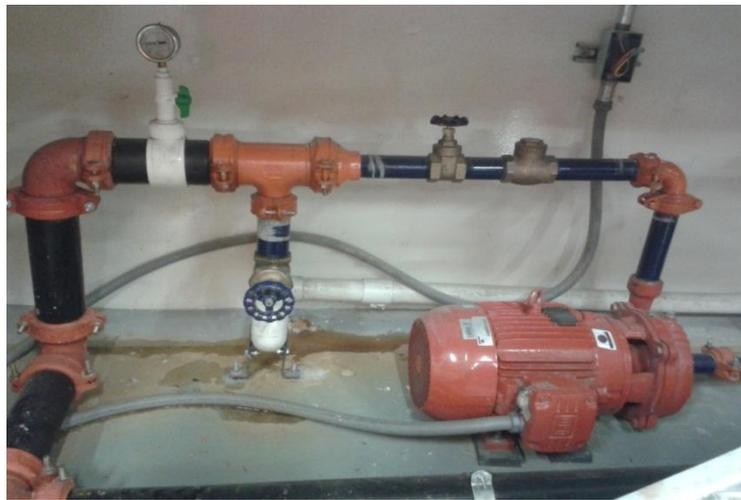
Figura 3-12. Motobomba centrífuga usada en el montaje de laboratorio.
