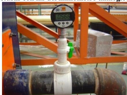
Figura 3-18. Manómetro electrónico en funcionamiento.
