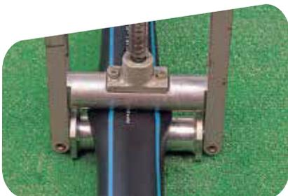
3. Se retira la herramienta desenganchándola de la Tubería, para dar paso al flujo de agua.
