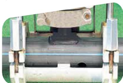
5. Después de dejar que la unión realizada se enfríe 3 minutos más, retire el tubo con el accesorio soldado de la máquina.
