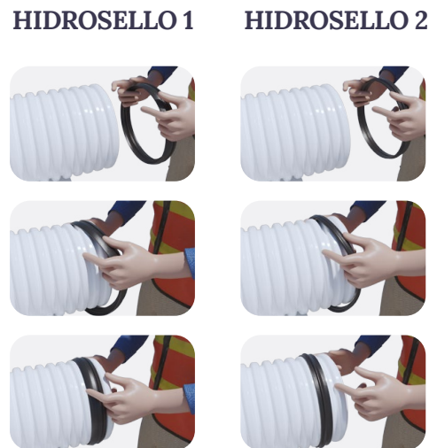
Figura 6.4. Colocación hidrosellos de caucho
