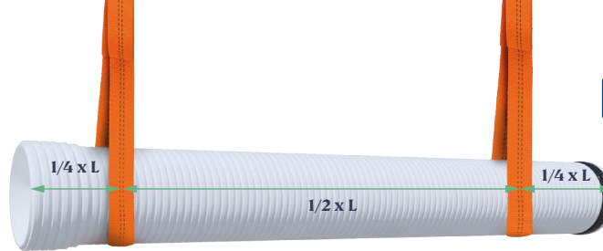
Figura 5.9. Alzaje de la tubería
