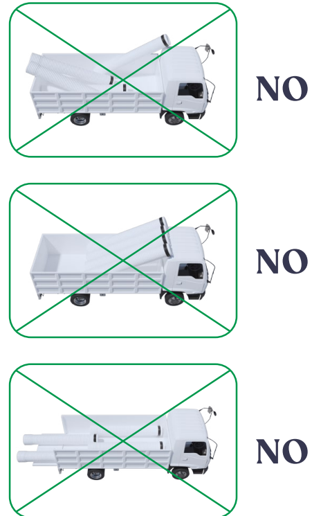
Figura 5.1. Colocación de las tuberías en el camión
