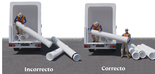
Figura 5.8. Descarga del camión
