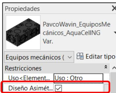
4. Si la forma completa de su tanque no es rectangular ni cuadrada, deberá activar la casilla "Diseño Asimétrico"
