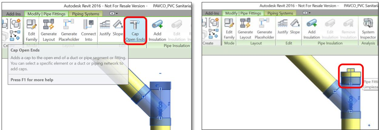
En caso de hacer los mismos pasos con una tubería de 2 a 6 pulgadas y que tenga un extremo libre, se debe cambiar el accesorio insertado por un tapón de prueba como se muestra a continuación:
