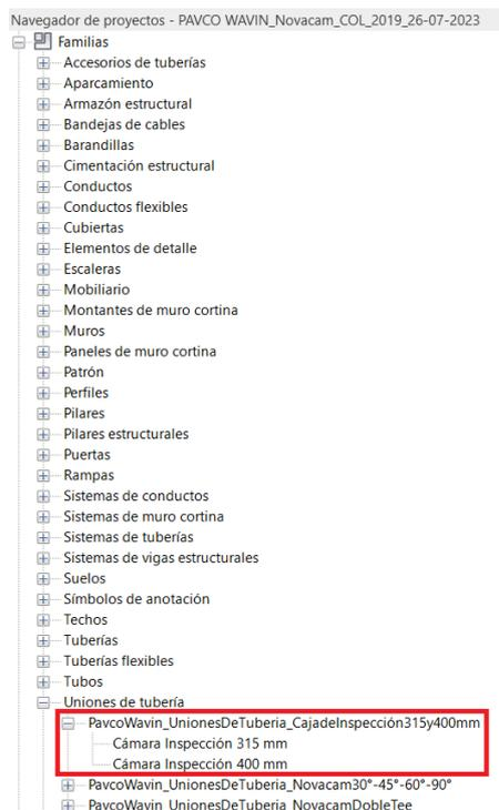
Dentro de la familia se encuentran dos tipos, el primero hace referencia a “Cámara Inspección 315 mm” y el segundo “Cámara Inspección 400 mm”, la selección de cada tipo permite cambiar las propiedades de la familia. La base de 315 mm cuenta con tres entradas, una de 160 mm y dos de 110 mm y una salida de 160 mm.
