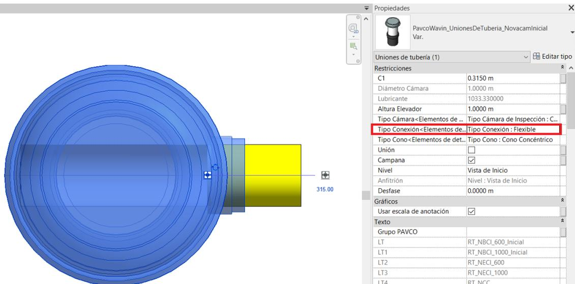
Al utilizar una conexión flexible, la tubería Novafort se conecta a la campana de la terminación de conexión. En el caso de la conexión fija, la tubería se debe conectar con una campana o una unión para el empate a la conexión, debido a que este tipo de conexión es de terminación espigo. Por defecto la conexión fija en la familia activa la visibilidad de las campanas de la tubería, en caso de requerir unión se puede utilizar las casillas “Unión” en las propiedades de la familia.
