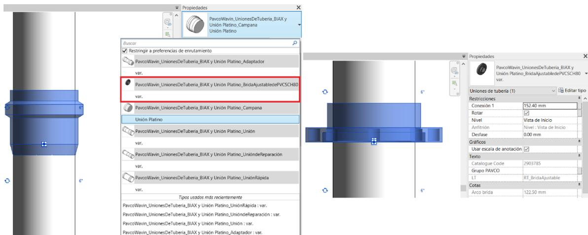
Si requiere rotar la brida, puede utilizar el parámetro “Rotar” para cambiar la orientación de la unión de tubería.
