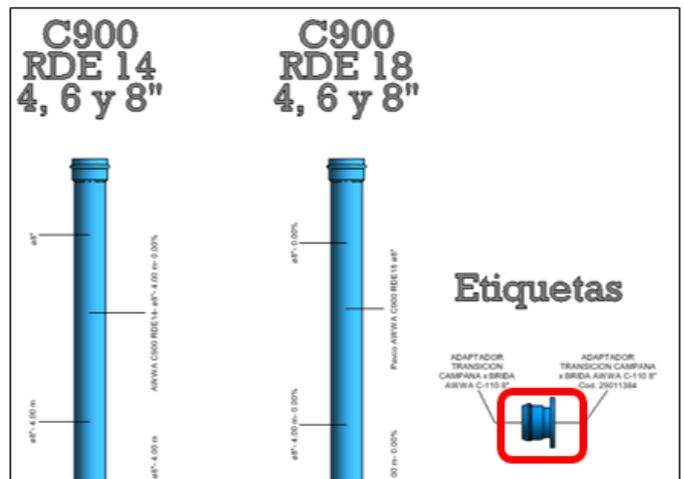
Es necesario copiar este accesorio manualmente porque no viene en las preferencias de enrutamiento de las tuberías C900 para que los accesorios AWWA C110 funcionen sin insertar la brida en casos innecesarios. Cuando necesite usarla para una transición en el proyecto agreguela a las preferencias de enrutamiento del tubo C900 de la siguiente manera:
