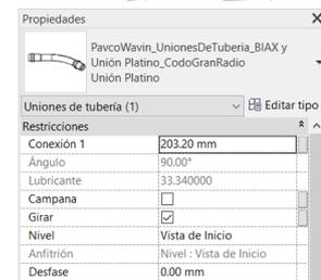
Si quiere cambiar los codos de gran radio por radio corto de tipo unión mecánica, seleccione el accesorio anteriormente creado y en las propiedades de familia cambie por “CodoRadioCorto”, tenga en cuenta que este tipo de codos unicamente está en angulos de 90° y 45°.
