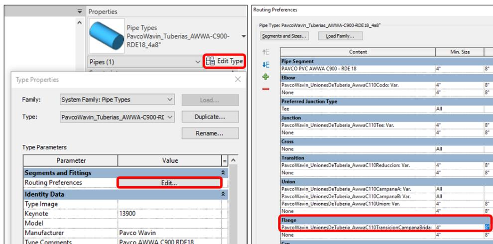
Una vez realizado el anterior ajuste ya puede insertar la brida automáticamente cuando divida las tuberías o inserte accesorios.
