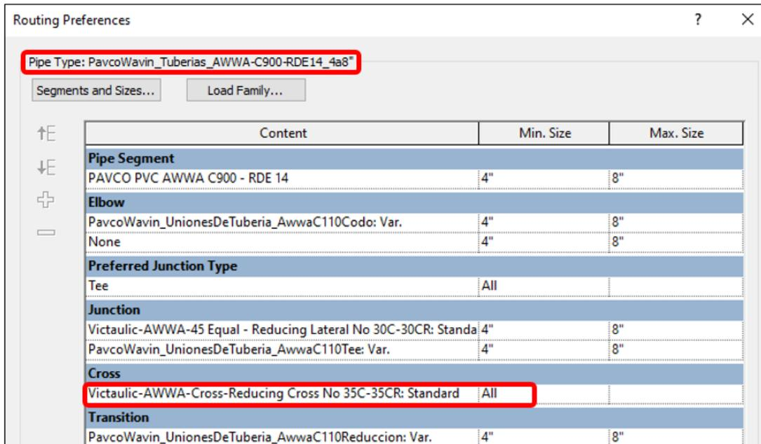
Al aplicar los cambios podemos crear una cruz y automáticamente colocara las 4 bridas en los conectores:
