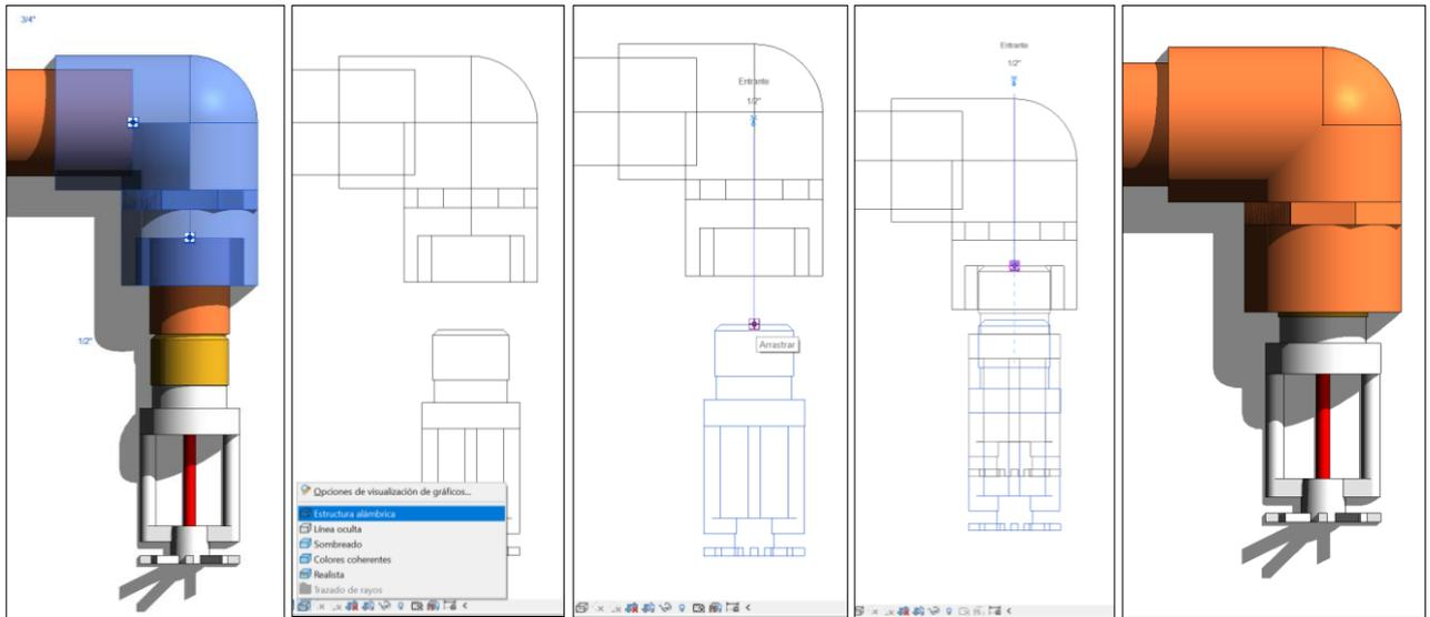
Además, al dibujar dos tuberías de 1/2" a 90 grados un codo con signo de admiración será insertado. Este codo no existe en el portafolio de Pavco pero está habilitado en Revit para permitir el funcionamiento de herramientas como "Conectar a" y generar conexiones de manera fácil con tubos de 3/4" en adelante:
