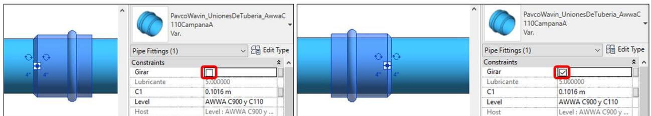
**NOTA:** La campana B se muestra como si los tubos estuvieran sobrepuestos. De esta forma las cantidades de tubos incluyen la longitud de la campana y esta alternativa no genera interferencias entre los tubos al usar el Clash Detective en Navisworks pero en Revit si al ejecutar la comprobación de interferencias entre tubos.
