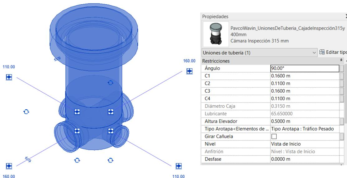
La base de 400 mm cuenta igualmente con tres entradas, una de 200 mm y dos de 160 mm y una salida de 200 mm. Para ambas la configuración es tipo Tee.
