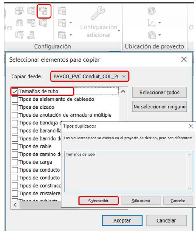
**Caso 2:** En el proyecto/plantilla donde va a importar las librerías si se han creado o modificado los tamaños de tubo en la configuración eléctrica de Revit.
