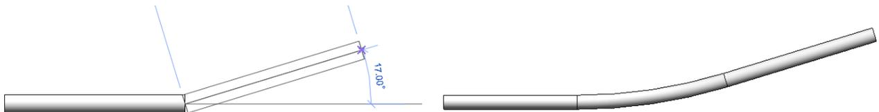
Teniendo en cuenta las características del material es posible cambiar los radios de Curvatura. Para hacer esto seleccione el elemento y cambie el valor en la ventana de Propiedades del parámetro Radio Curvatura. El valor por defecto es 3200 mm. En caso de que se asigne un valor mayor al Radio Permissible, no podrá ser cuantificado en la tabla de cantidades.
