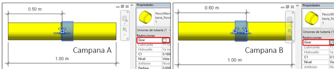
**NOTA:** La campana B se muestra como si los tubos estuvieran sobrepuestos. De esta forma las cantidades de tubos incluyen la longitud de la campana y esta alternativa no genera interferencias entre los tubos al usar el Clash Detective en Navisworks pero en Revit si al ejecutar la comprobación de interferencias entre tubos.
