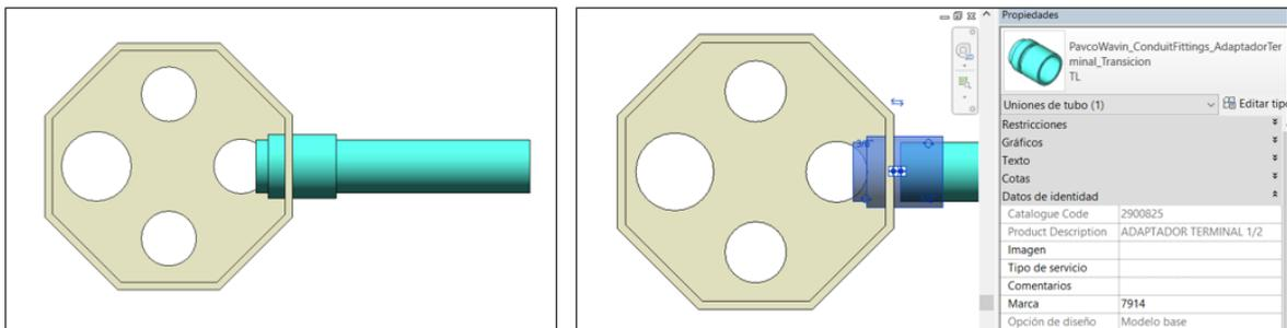
En caso de querer usar los adaptadores terminales de esta forma en **diámetros mayores a 3/4"** o en familias de Revit de otras librerías, debe modificar el diámetro de los conectores en las familias como se muestra en la siguiente tabla para que la transición se genere automáticamente:
