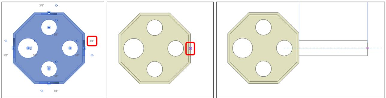
Al terminar de dibujar el tubo se inserta automáticamente el adaptador terminal de acuerdo al diámetro y tipo de tubo. Para los tubos **TL y Conduflex** ambos usaran el **adaptador TL**, mientras que el Tubo **SCH40** usara el **adaptador SCH40** de color gris:
