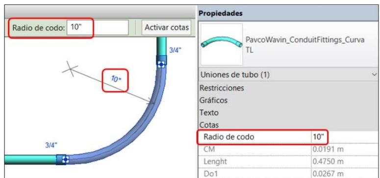
Estos **radios mínimos** también pueden ser modificados en la configuración eléctrica: Comando **“ES”** → Configuración de Tubo → Tamaño. Una vez en esta ventana se selecciona la Norma deseada, se elige un diámetro y en modificar tamaño se cambia el radio mínimo (se puede digitar el valor en **cm**).
