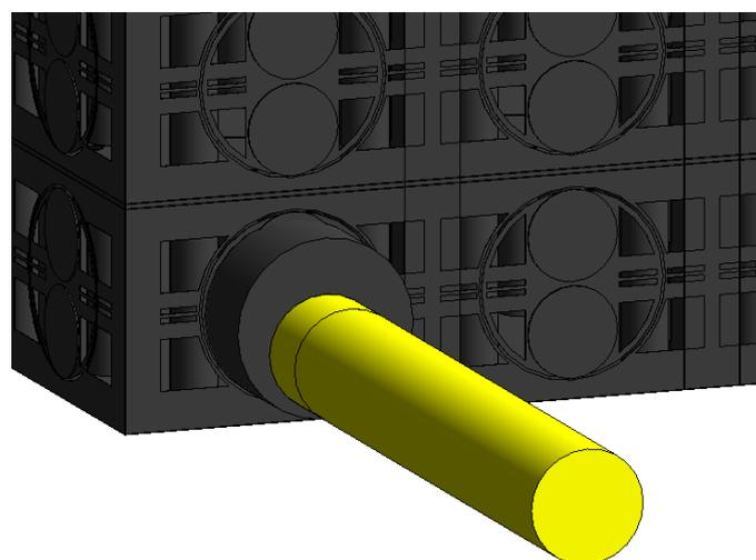
Puede cambiar el sentido de la excentricidad, seleccionando el Adaptador y haciendo clic en la opción **“Girar Conector”** en la ventana de *Propiedades*. Funcionará en 160mm y 200mm.
