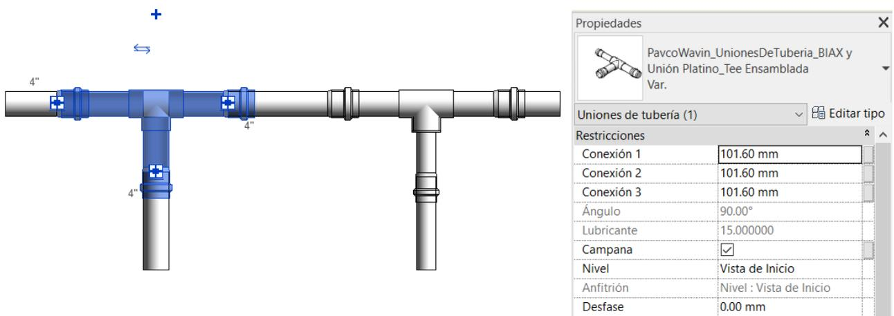
Las Tees Ensambladas tienen extremo CampanaXEspigo, por defecto ya viene activa la visibilidad de la campana de la tubería para el extremo de la tubería, pero si desea desactivar la campana de la tubería, puede utilizar el parámetro "Campana" para desactivar la visibilidad de la campana de la tubería.
