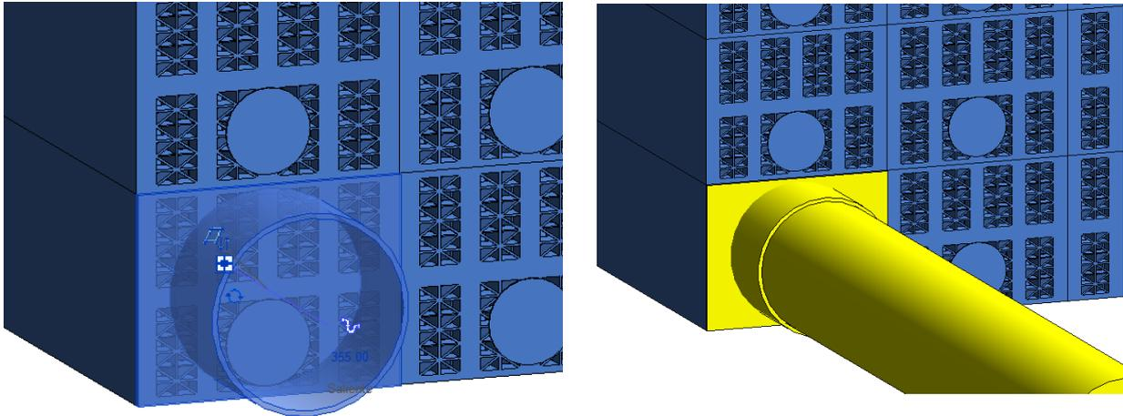
Si realiza una salida en 160mm, puede cambiar el sentido de la salida, seleccionando el Adaptador y haciendo clic en la opción **“Girar Conector”** en la ventana de *Propiedades*.
