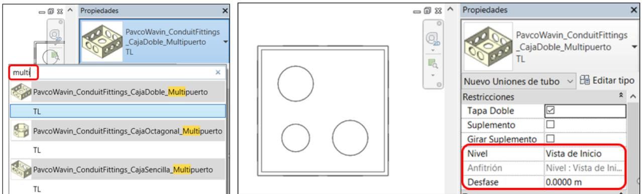
Luego de ubicar la caja use la tecla espacio para girarla o con las flechas de Rotar, seleccione con clic derecho un conector y de clic en *Dibujar tubo*. Al dibujar el tubo se inserta automáticamente el adaptador terminal:
