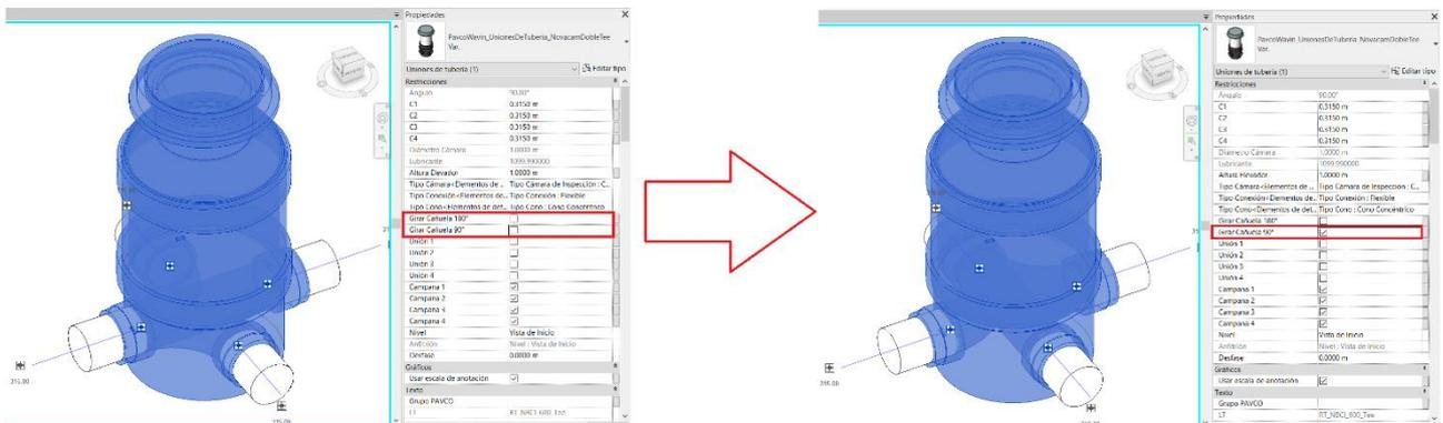
12.2.4.6 Base Cámara Inspección 1000 mm Tipo Tanque (sin cañuela)
