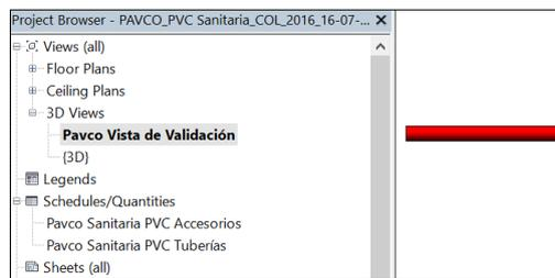
b) Divida la tubería en secciones usando el comando *Split Element* (SL en el teclado), clic en alguna parte de la tubería y ubique la unión que aparece de acuerdo a la máxima longitud disponible.
