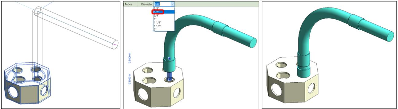
Además, puede conectar las cajas arrastrándolas desde los conectores hacia el tubo e intentar diferentes conexiones que no se logran con las demás variantes de cajas:
