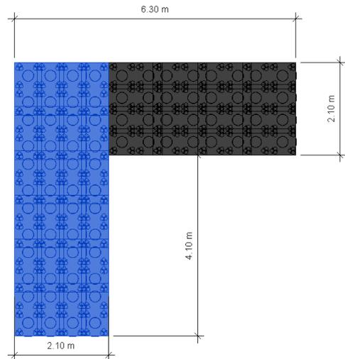
1. Ubique las dimensiones del tanque, estas serán utilizadas en los pasos siguientes. (También calcule la altura del tanque)
