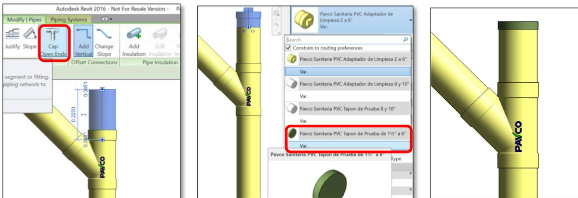
Al momento de usar *Cap Open Ends* en tuberías con diámetro de 8 o 10 pulgadas, un adaptador de limpieza tipo campana es insertado. Este adaptador solo debe ser utilizado en tuberías y no en accesorios. Además, se pueda cambiar por un tapón de prueba.
