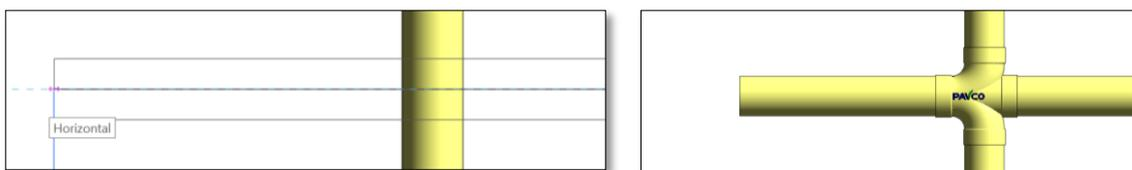
e) Una Doble Tee se puede cambiar por una doble Yee con codos Campana x Espigo:
