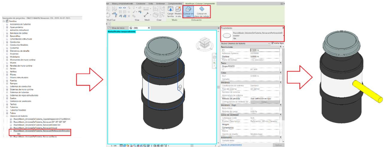
La perforación se colocará por defecto con la opción “Colocar en cara”. La ubicación de esta familia sobre el elevador de la cámara de inspección le permitirá contabilizar el adhesivo epóxico que se utiliza para conectar la tubería Novafort.
