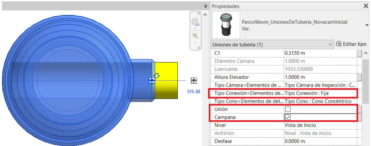
El ángulo de restricción varía según la conexión, para conectores flexibles se utiliza un ángulo máximo de 7.5° y para conectores fijos el ángulo es de 4°. La aplicación de este ángulo dentro de Revit se realiza a través de la configuración de la tolerancia. Con el comando MS ingrese en la “configuración de tuberías” y asigne en el parámetro de “Tolerancia de conector de tubería” y asigne el ángulo en función del tipo de conexión que se configure en las familias.
