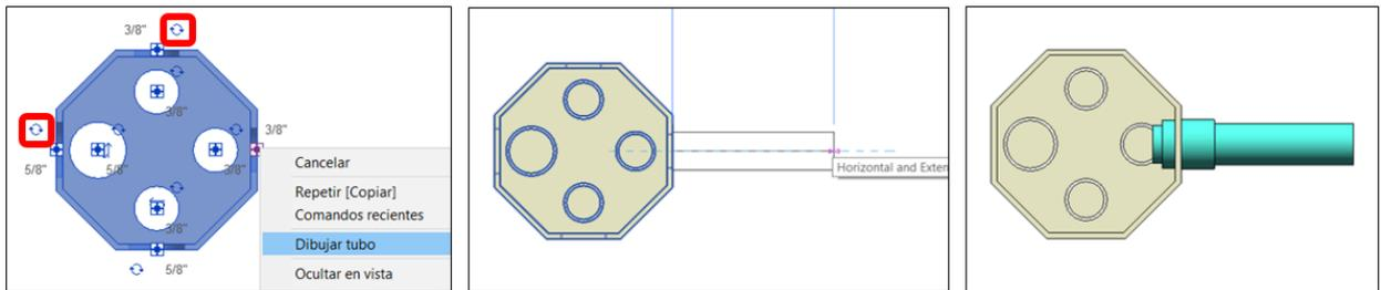
A veces puede pasar con la opción *Dibujar tubo* o al hacer **tubos verticales** que se genere un tubo de 3/8” o 5/8”, estos tubos deben seleccionarse y cambiarse a 1/2” y 3/4” respectivamente para que se inserten automáticamente los adaptadores terminales:
