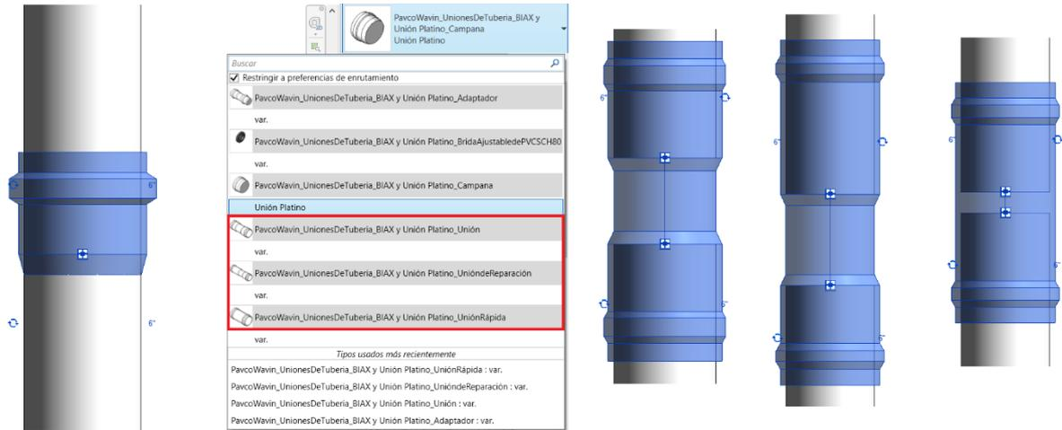
En la línea Unión Platino, existen tres tipos de uniones; Unión estándar, Unión rápida y Unión de reparación, todas están en el rango de diámetros desde 2” hasta 12”.
