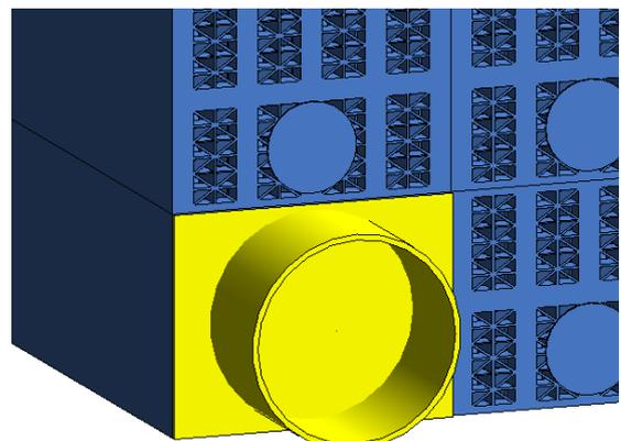
Para iniciar una conexión desde el Adaptador (Conector) selecciónelo y se activará el símbolo de conector desde donde podrá dibujar una tubería saliente.
