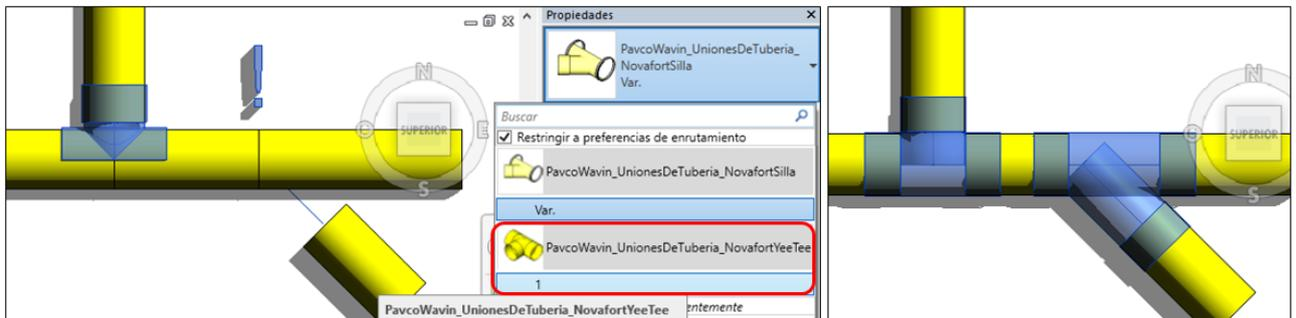
Para insertar la Tee Doble de 12x6” (315x160mm) seleccione una Silla Tee de 12x6” y de clic en la herramienta **Cruce** para que aparezca la Tee Doble o también puede dibujar una cruz con un tubo de 12” y uno de 6”:
