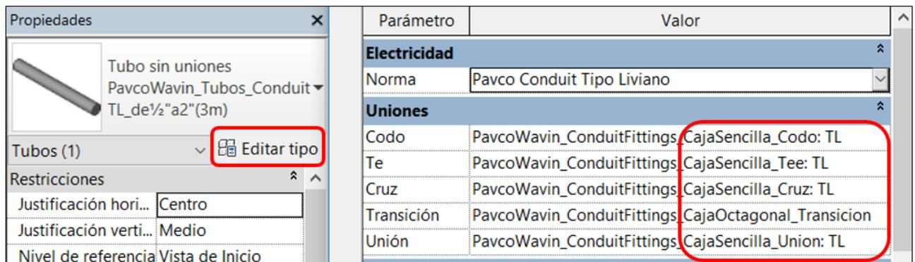
Para **girar las cajas** se recomienda usar las herramientas *Rotar* o *Voltear unión* que aparecen cuando seleccionamos un accesorio. En caso de no encontrar el simbolo de estas herramientas se recomienda cambiar la escala de la vista a "1:10" o "1:20". Tambien, algunas cajas tienen habilitada la casilla *Girar Caja* en el area de propiedades:
