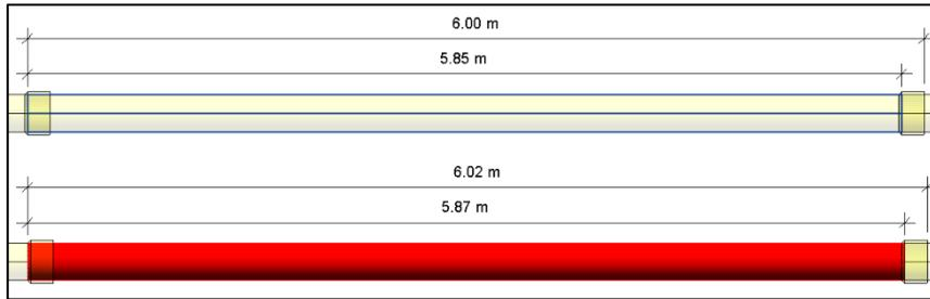
y puede asistirse de la “**Vista de validación A**” (ver sección [1.3](#) para importar plantillas de vista). Podrá ver que dejaran de ser rojos cuando se inserte la campana tipo A de manera que no sobrepase la longitud útil.
