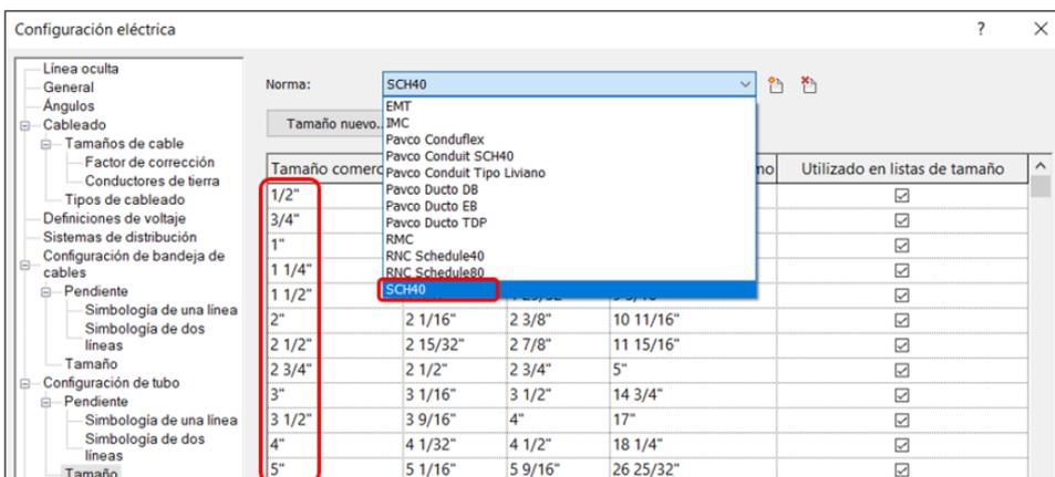
Una vez que se ha creado los tamaños para la Norma SCH40 podemos transferir las normas de los Tamaños de tubo como en el caso 1. En caso de no realizar este procedimiento, se puede generar un error al dibujar tubos de Conduit. Una vez que los tamaños de tubos Pavco estén en el proyecto se puede copiar los tubos,
