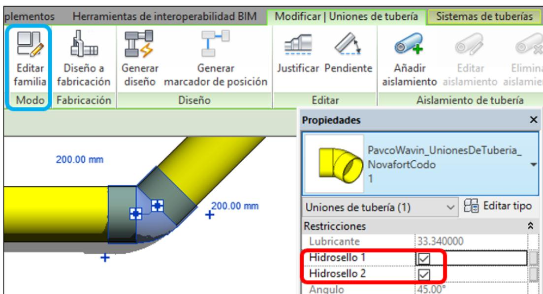
Los hidrosellos no son visibles en las vistas del proyecto, pero si se cuentan en la tabla de cantidades dependiendo de las casillas mostradas anteriormente. Según el tubo que se use, cada accesorio genera el hidrosello específicamente para su diámetro (algunos tubos S8 y S4 Plus requieren un hidrosello diferente para el mismo diámetro nominal).
