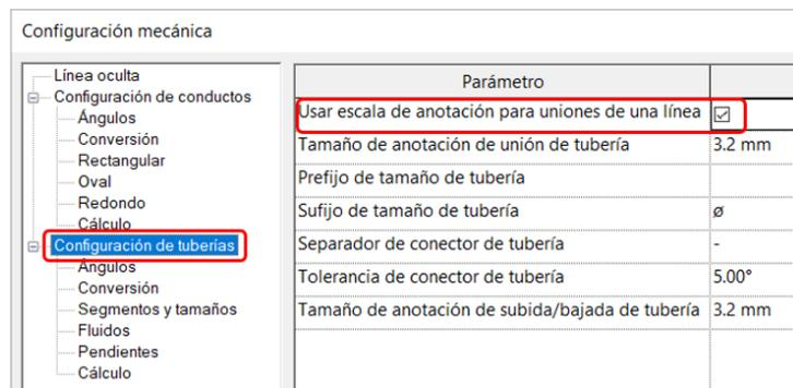
Es necesario activar este parámetro antes de empezar a dibujar los sistemas. En caso de que no se haya activado desde el inicio se deben escoger todos las Uniones de tubería (Pipe Fittings) que se han insertado en el proyecto (una opción es seleccionar todos los elementos del proyecto y usar la herramienta “Filtro”) y en el area de Propiedades activar la casilla “Usar escala de anotación”:
