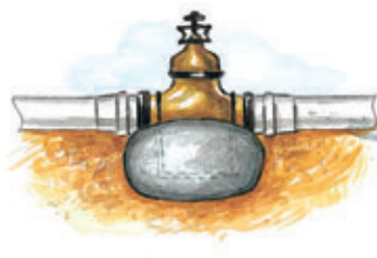
ANCLAJE DE VALVULA
