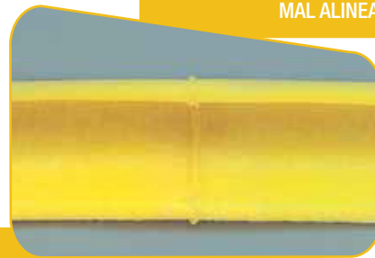
CON RANURA O VACÍOS ENTRE TUBOS
