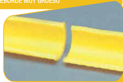
FUNDIDO CASI FRÍO POCO TIEMPO Y Poca TEMPERATURA
