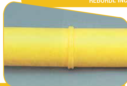
DEMASIADA PRESIÓN Y TEMPERATURA REBORDE MUY GRUESO
