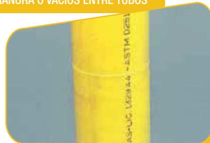
FUNDIDO A BAJA PRESIÓN REBORDE INCOMPLETO
